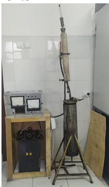
Рисунок. Лабораторная установка получения активированных углей из органического сырья: 1 – емкость для воды; 2 – манометр (образцовый); 3 – медный капилляр; 4 – парогенератор; 5 – печь карбонизации и активации; 6 – латоры; 7 – милливольтметры; 8 – холодильник; 9 – приемник; 10 – газовый счетчик; 11 – стабилизатор давления; 12 – карман термопары
