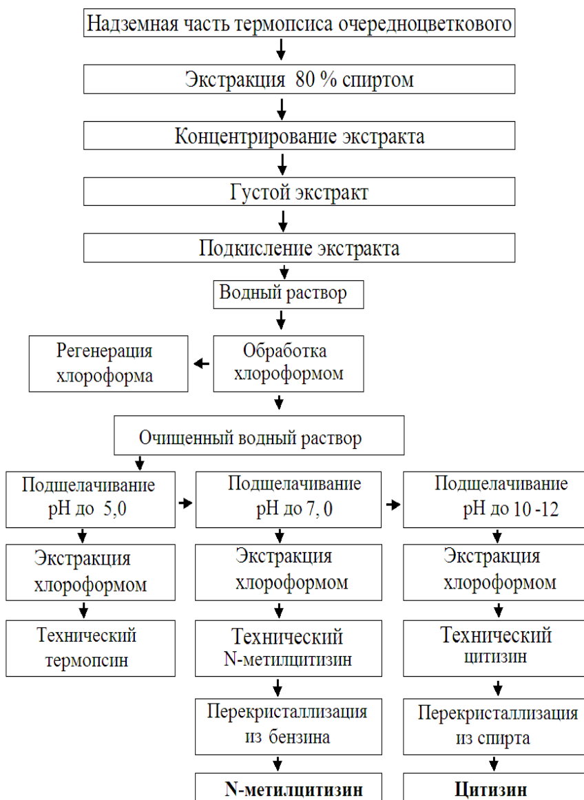
Рис. 2. Блок-схема получения субстанций цитизина и N-метилцитизина
