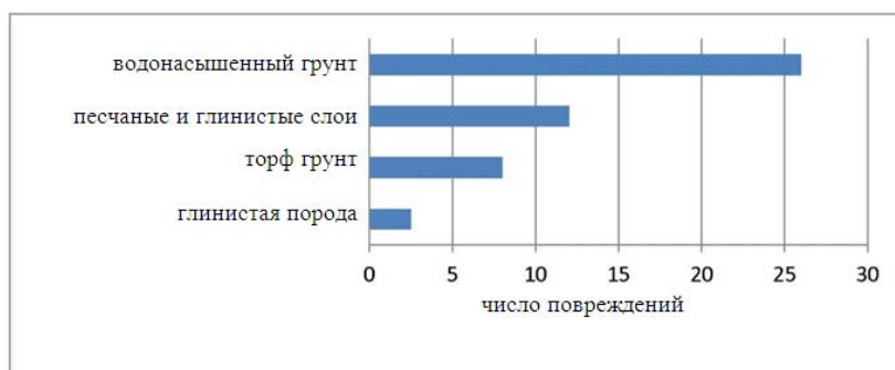
Рис. 1. Повреждения трубопроводов, проложенных в различных грунтовых условиях
