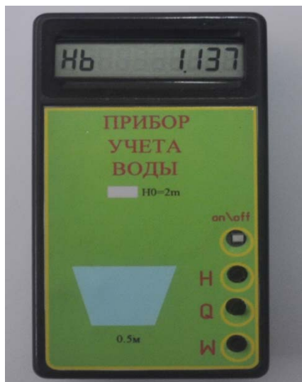
5-расм. ТИМИ - 3 сув сарфи ва ҳажмини ўлчаш ускунаси
