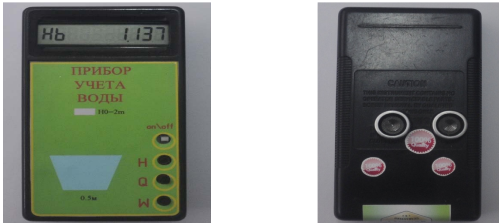
Рис. 5. Прибор ТИИМ-3 для измерения расхода и объёма воды
