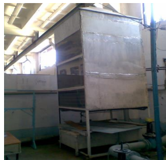
1- исследуемый ороситель; 2- водоуловитель; 3- распылитель; 4- вентилятор; 5- емкость; 6- насос; 7- электронагреватель; 8- нагревательная ёмкость; 9- микроманометр; 10- смотровые окна
