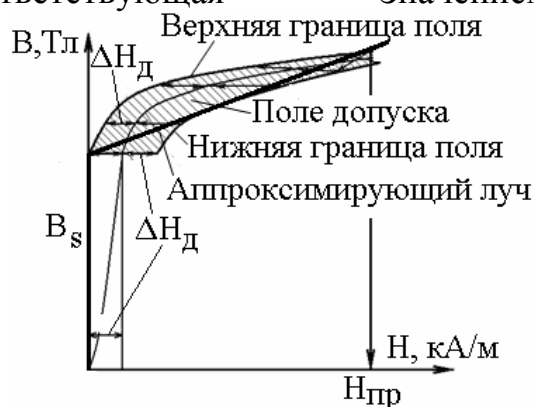
Рис. 2. Построение СХН по заданному значению погрешности расчета
