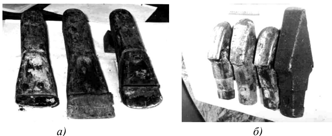
Рис. 14. Общий вид клиновидных зубьев ковшей экскаваторов ЭО - 4121 (а) и ЭО - 3322 (б)
