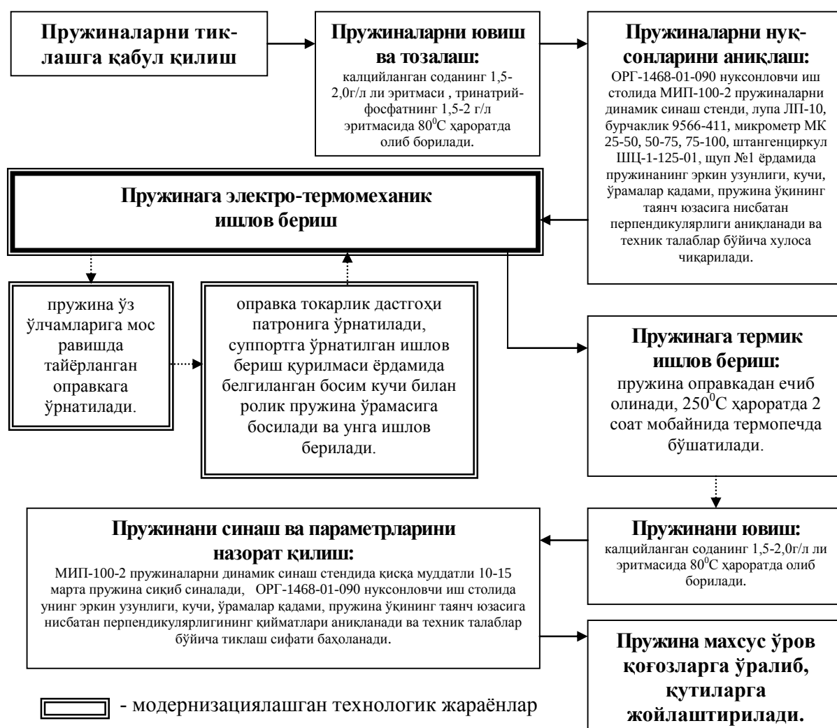
8-расм. Пружиналарни электро-термомеханик усулда тиклаш технологик жараёни
