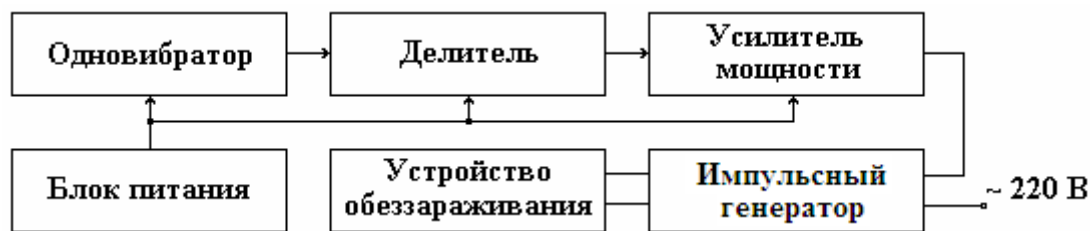
Рис. 7. Функциональная схема устройства управления импульсным генератором
